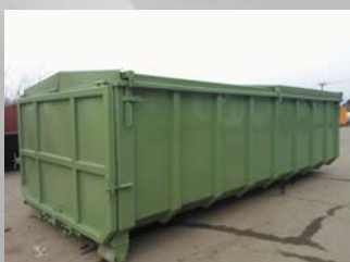
Abroll s posuvnou střechou
